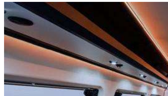
Circuit d'éclairage intérieur Tourisme avec Technologie LED
